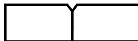
Normale Fase (ab 0,55 mm Nutzschicht möglich) normal bevel (requires top wear-layer at 0.55+ mm)
